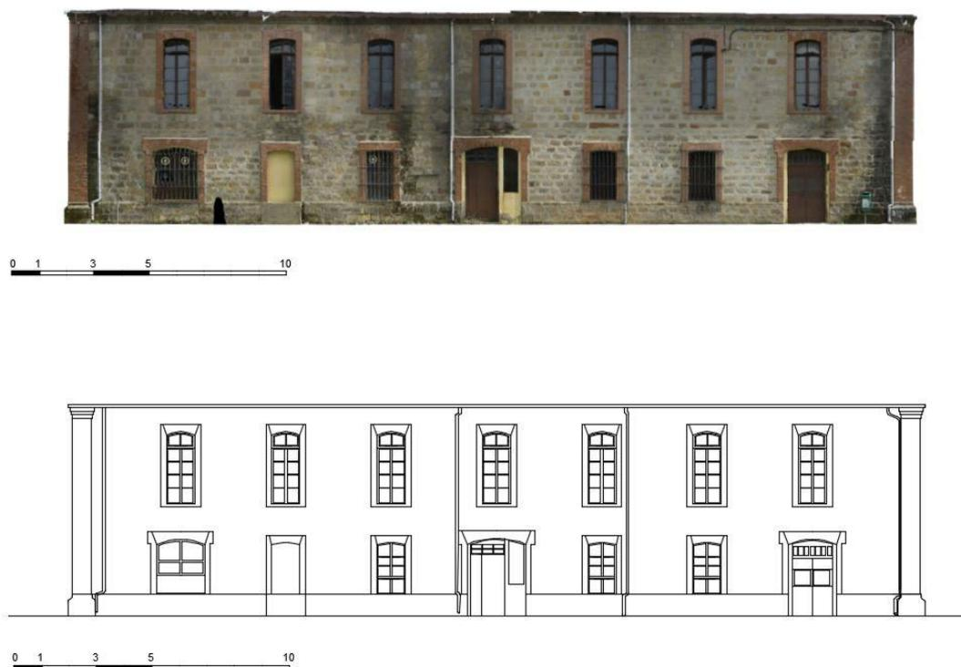
Ortoalzado y alzado delineado en AutoCAD de la fachada oeste de la sala de máquinas / Fuente: Elaboración propia.
