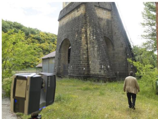
Proceso de escaneo del edificio / Fuente: Elaboración propia.
