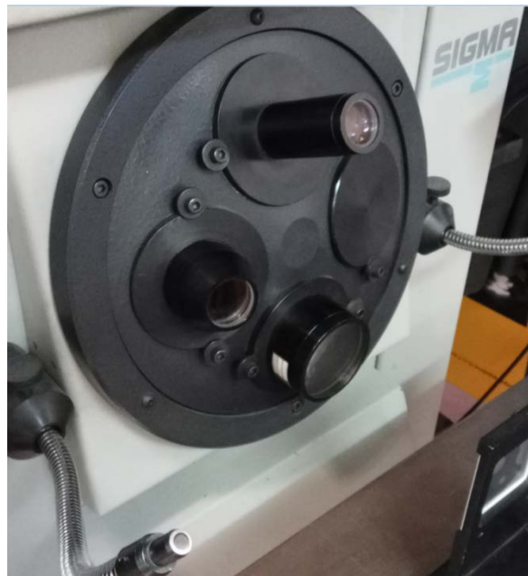
Imagen 14 .- Fuente de Luz y Sistema Óptico
