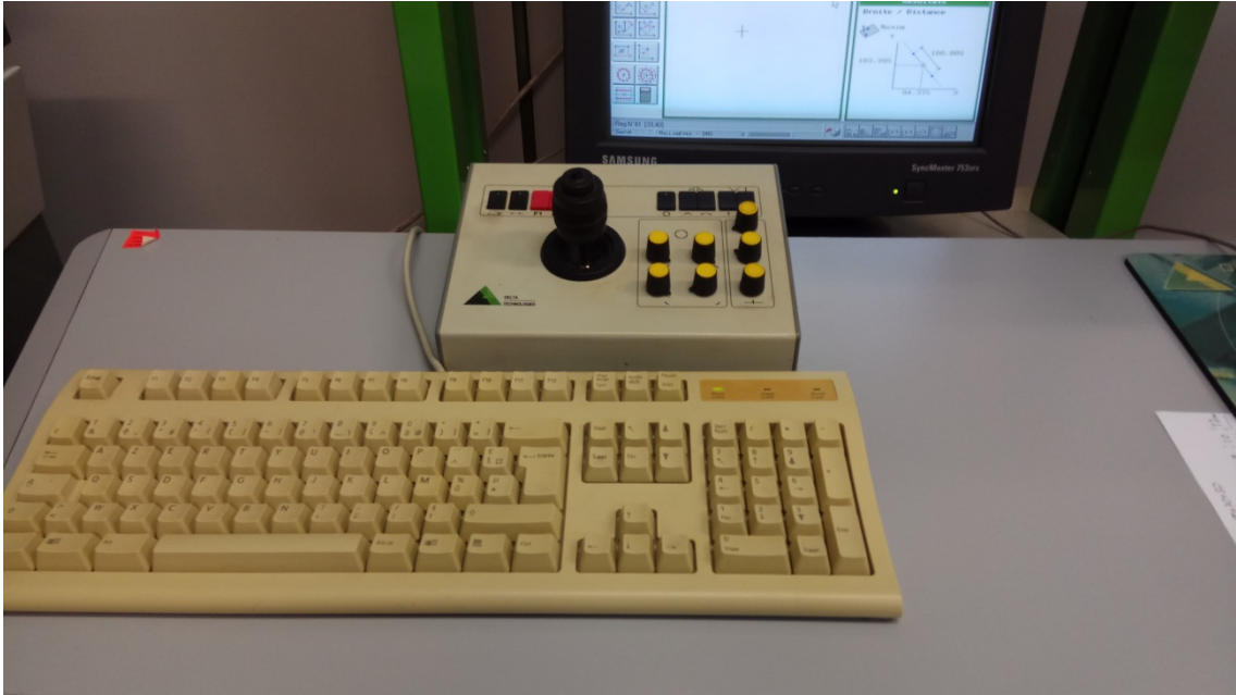
Imagen 20 .- Consola Movimientos de la Mesa y Control Modo de Iluminación
