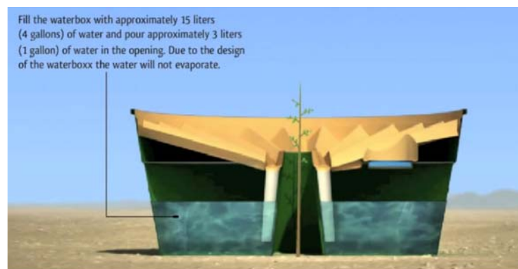
Imagen 3.- Deposito parcialmente lleno para aumentar peso y sujeción a terreno
