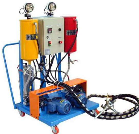
Figura 31. Tanques, panel de control y manguera
