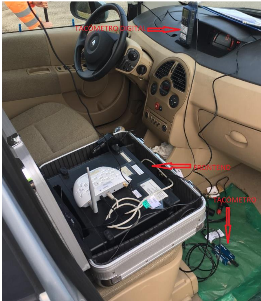
Figura 18. Elementos de la cadena de medida que se transportan dentro del vehículo.
