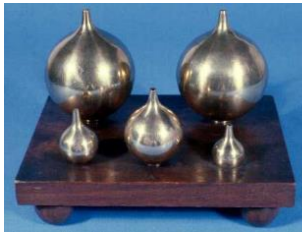
Figura 30. Cavidad Rígida del resonador de Hemholtz [21].
