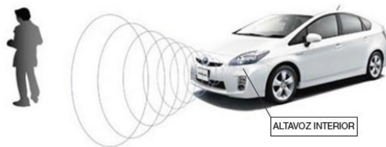
Figura 26. Representación del sistema acústico de advertencia instalado en el modelo prius de Toyota [13].
