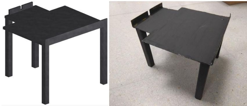
Figura 4.25 Soporte diseñado en CATIA V5 (izq.) y soporte de apoyo del posicionador (dcha.).
