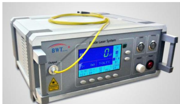
Figura 5.11 Sistema de control del láser de diodo utilizado en el equipo.
