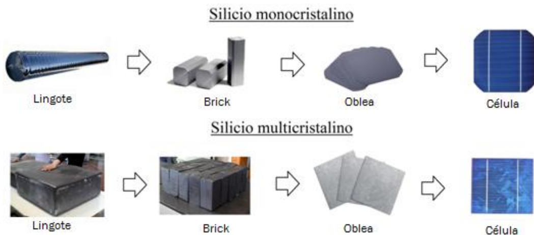
Figura 3.11 Proceso de fabricación de una célula a partir de silicio monocristalino y multicristalino.
