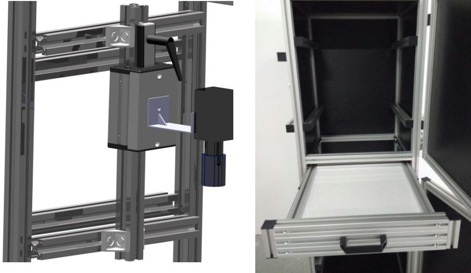
Figura 5.6 Sistema de sujeción de la cámara en reflexión (izq.) e imagen real de la zona superior del equipo en la que va colocado el soporte (dcha.).
