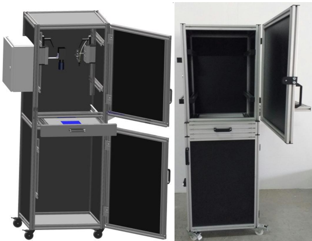
Figura 5.2 Vista del equipo diseñado en CAD (izq.), y equipo fabricado por “Fasten sistemas” (dcha.).
