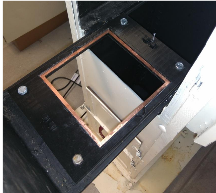
Figura 4.19 Bandeja en su posición de trabajo. El color negro evita la aparición de reflejos de luz en el interior de la cavidad.
