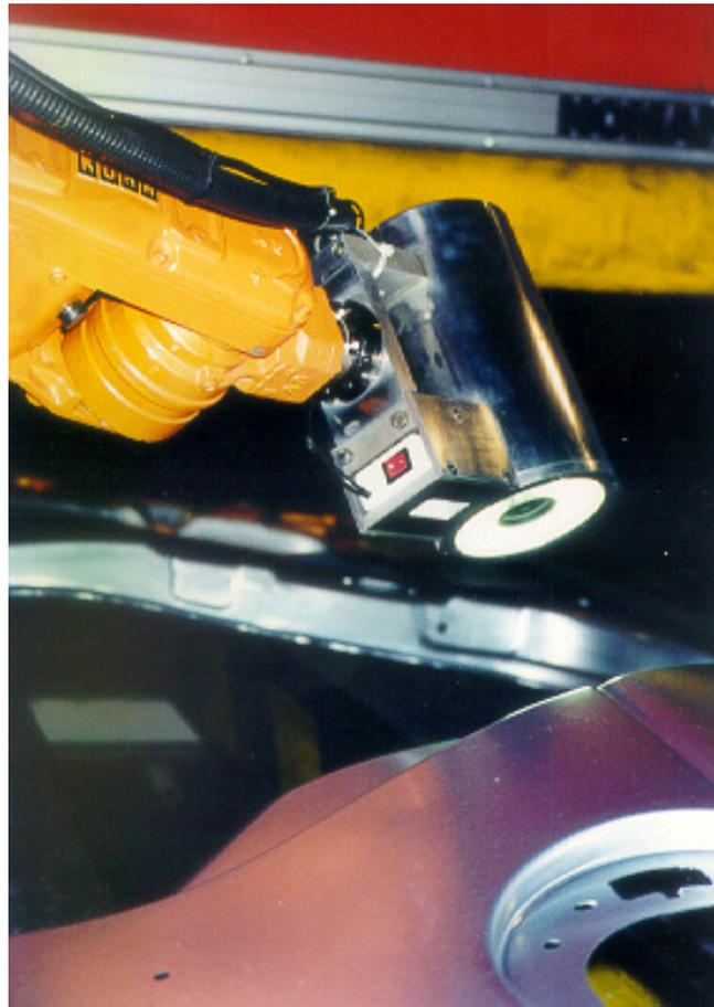
**Sistema de vision embarcado en un robot para la inspección de chapa.**
