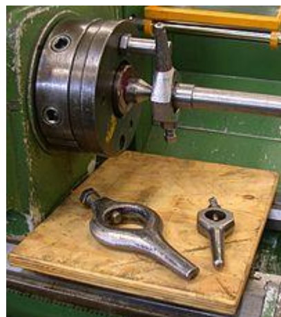
Figura 3.12: Pernos de arrastre y su colocación.
