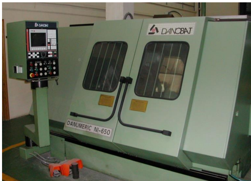
Figura 3.5: Torno de Control Numérico DANOBAT modelo DANUMERIC NI-650.
