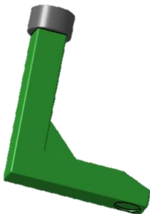
Figura 6.17: Brazo portante superior modelado en CATIA.
