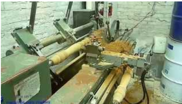
Figura 3.3: Torno copiadore realizando una réplica de un elemento de revolución de madera.
