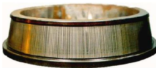
Figura 3.5 Formación de pequeños cráteres por descarga eléctrica [RAD2010]
