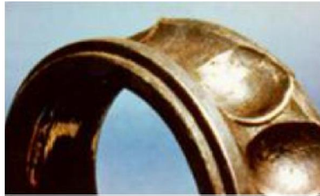
Figura 3.4 Deformación plástica del anillo interior por sobrecarga [RAD2010]
