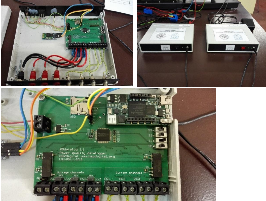
Figura 6.2 Zoom de la tarjeta de adquisición de datos [Foto laboratorio]
