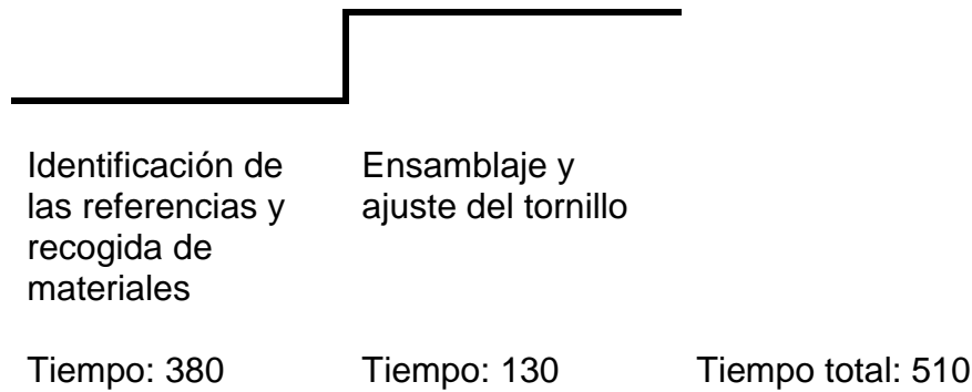
Figura 4.7 Análisis de las actividades con y sin valor añadido en la Fase 1
