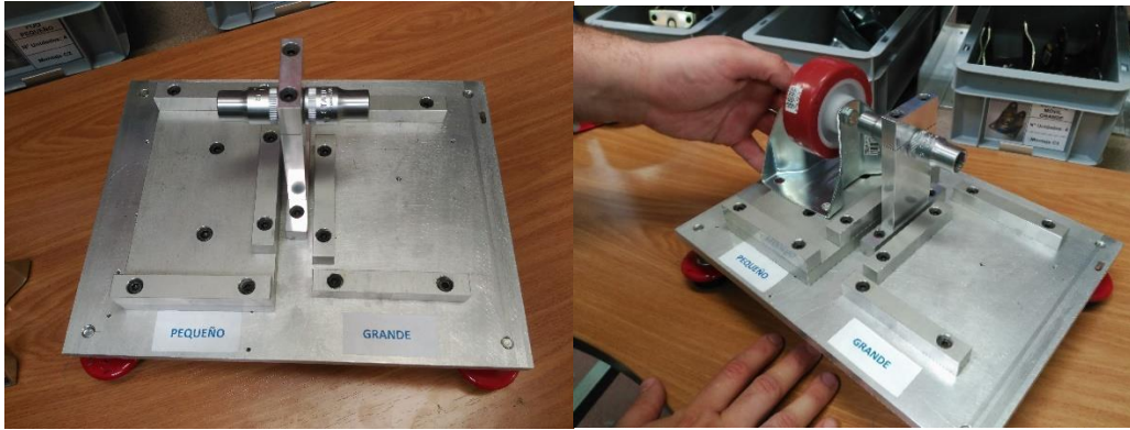
Figura 3.11 Útil Poka yoke
