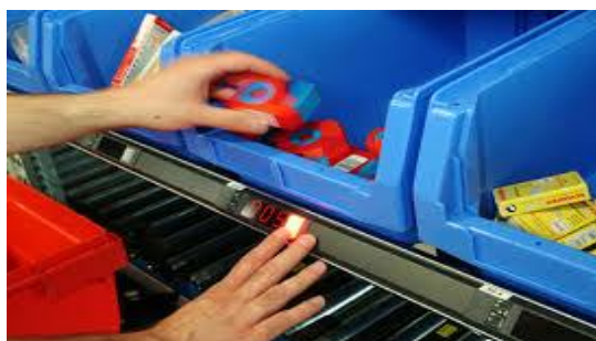
Figura 2.8 Ejemplo de sistema pick-to-light real. Fuente: http://www.ssi-schaefer.us
