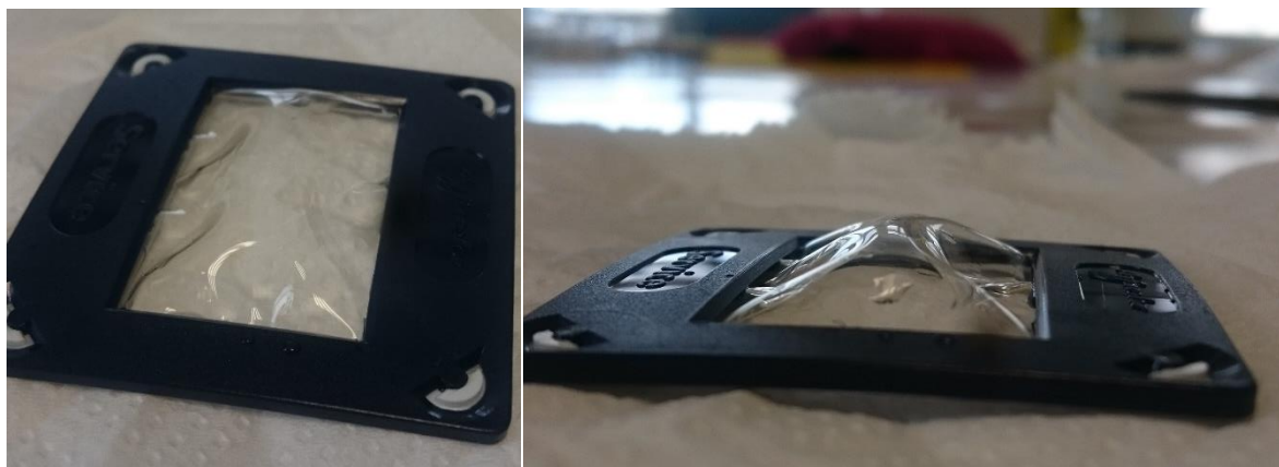
17) Expansión del Nafion dentro del marco de diapositiva
