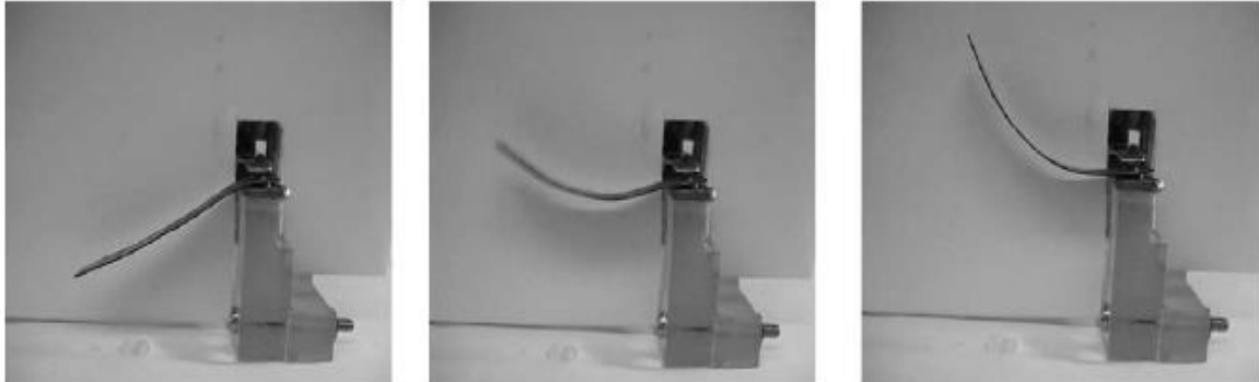
3) Barra IPMC (4cm*1cm*0.2mm) con una gran deformación (~4cm) con dos 2V aplicados. [4]
