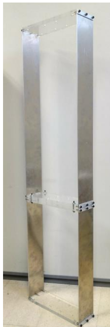
Figura 2.5: Maqueta del edificio de dos plantas
