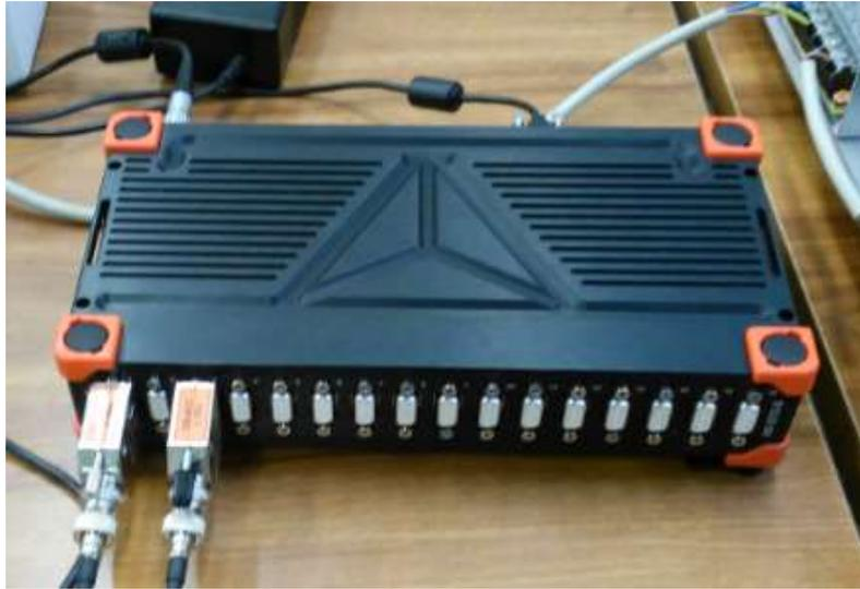
**Figura 2.5.** Dispositivo de adquisición de datos
