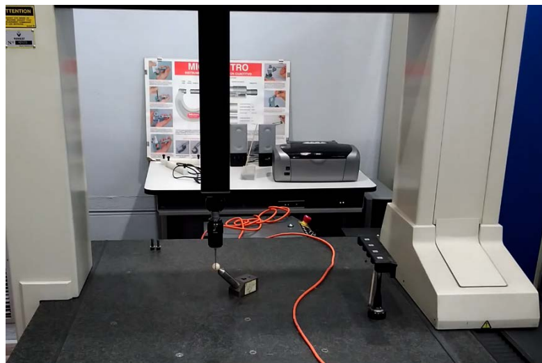
Imagen 6.4.3.II Cualificación del palpador
