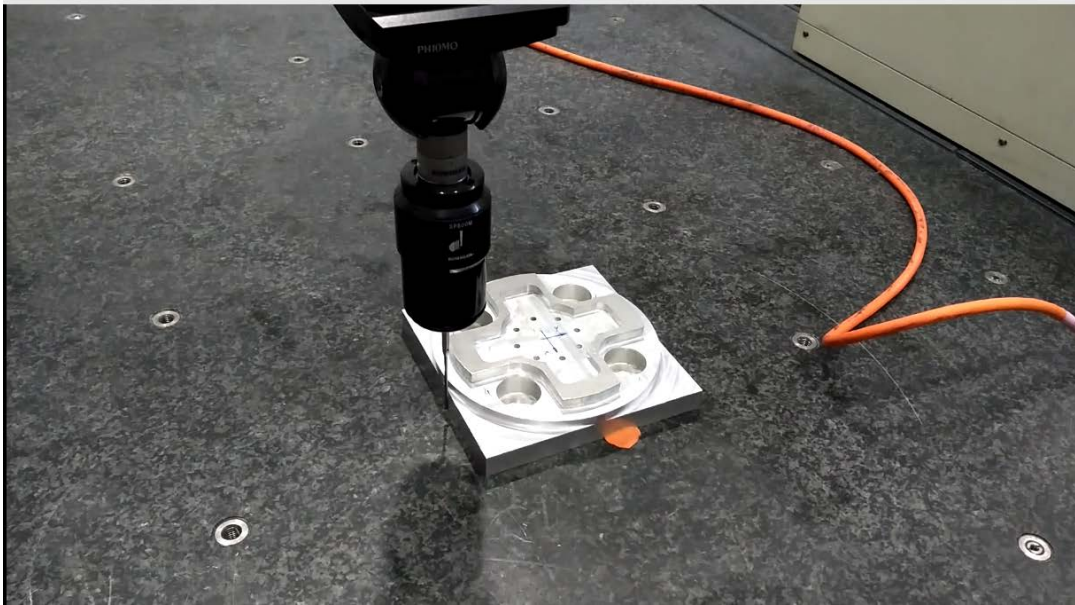
Imagen 6.4.3.III Proceso de medición en la MMC
