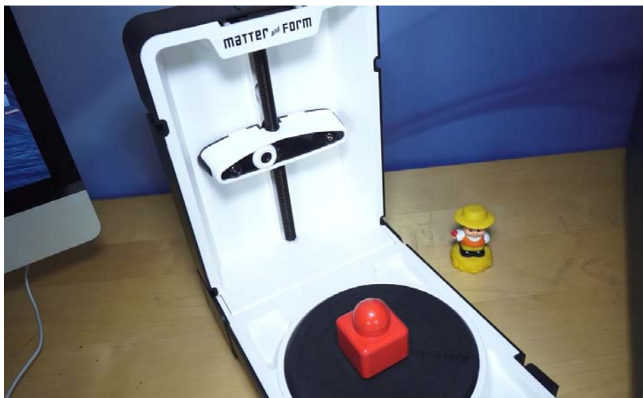
Imagen 4.IV Máquina de medición por coordenadas por cámara de visión. Imagen tomada de [24].
