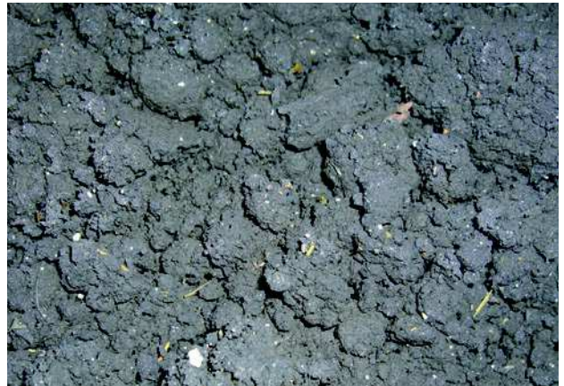
Lodos de depuradora deshidratados con un 35% de contenido de sólidos: no es un problema para una bomba de manejo de sólidos ABEL.
