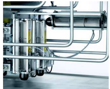
Sopladores tangenciales para refrigerar los cilindros de válvula
