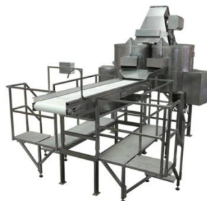
Figura 1.3.-Cinta de inspección.
