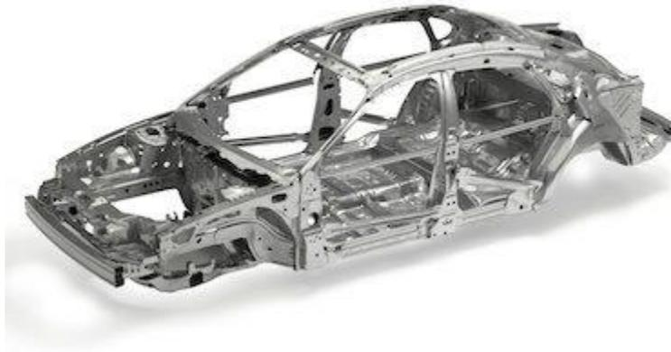
FIG. 2. PARTES DEL VEHÍCULO CONSIDERADAS COMO BIW.
