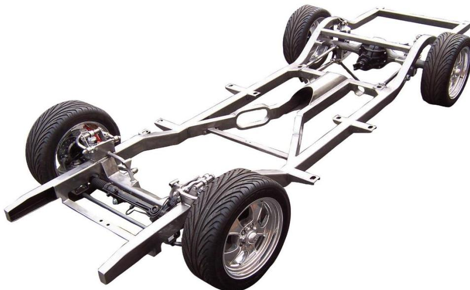
FIG. 4. PARTES DEL VEHÍCULO CONSIDERADAS COMO CHASSIS.
