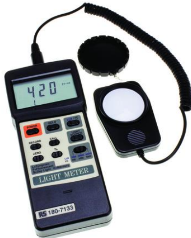
Figura 3.3: Luxómetro RS 180-7133 utilizado en las mediciones.
