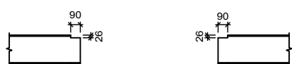
Detalle del recorte de la viga (c) IPE 270 Detalle del recorte de la viga (b) IPE 270
