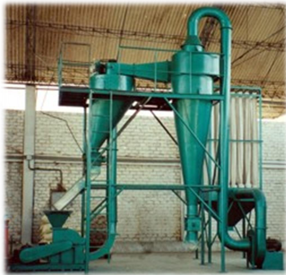
Ilustración 19: Sistema de eliminación de finos (ciclón y filtro de mallas)
