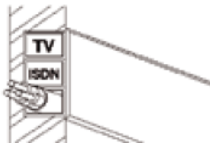
Ilustración 6: Cable multipolares en conducto perfilado empotrado
