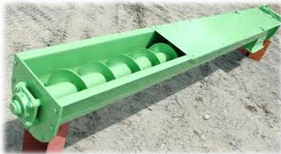
Ilustración 22: Tubería con tornillo sinfín
