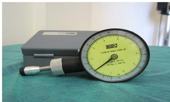
Figura 2._ Algómetro de presión con punta de goma y transductor de fuerza
