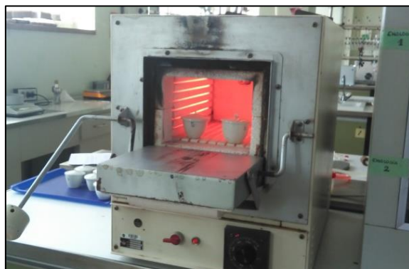
Figura 6. Mufla abierta para la determinación de materia volátil
