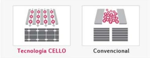
Imagen de los paneles LG, con tecnología Cello de alambres colectores.
