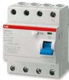
Para el funcionamiento de los interruptores diferenciales y su correcta protección deberá situarse un circuito a tierra por el que puedan derivarse las faltas. Para ello vamos a escoger el esquema de tierras TT (ITC-BT 24), según la norma: "Todas las masas de los equipos eléctricos protegidos por un mismo dispositivo de protección, deben ser interconectadas y unidas por un conductor de protección a una misma toma de tierra."
