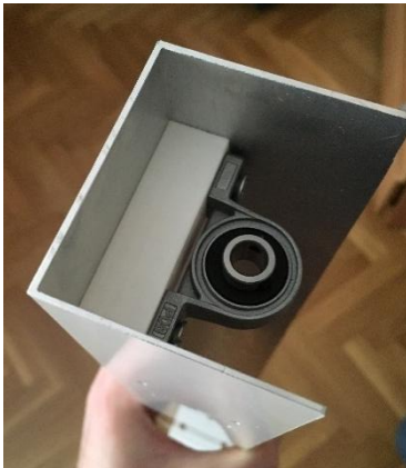
Figura 49. Rodamiento vertical en la torre
