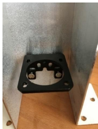
Figura 47. Soporte de motor atornillado en la torre
