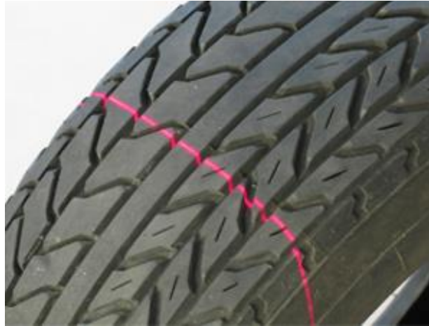
Ilustración 17 Inspección de neumáticos con haz de luz lineal
