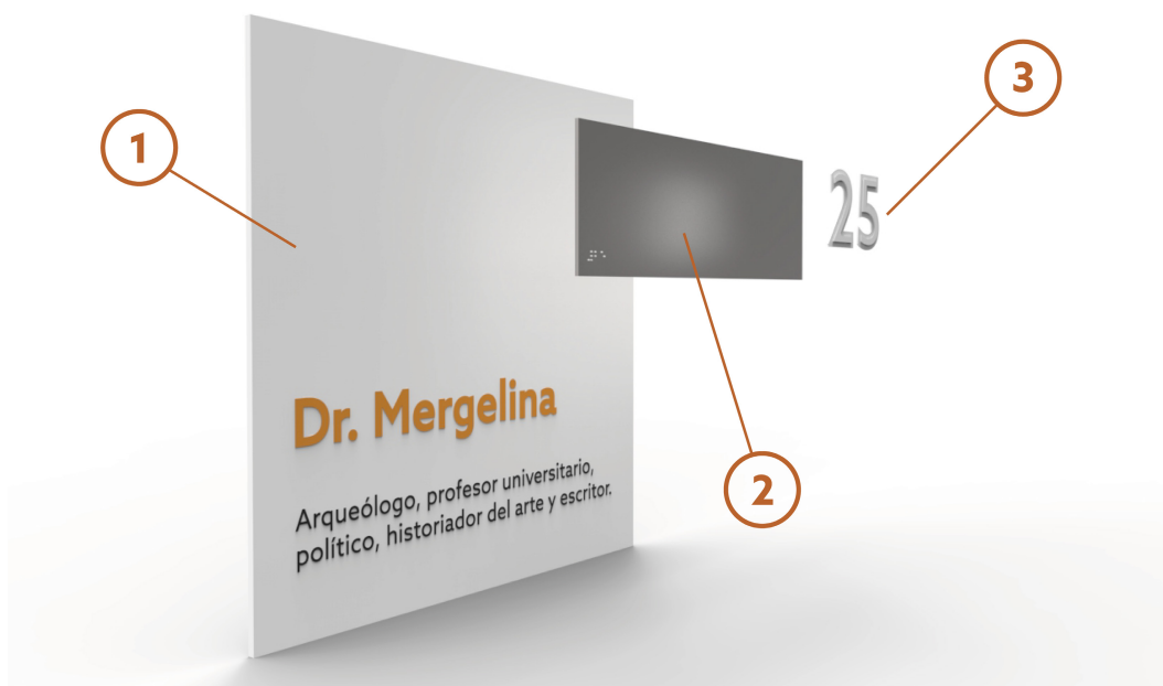
Vista explosionada de la señal identificativa de tipo placa de un aula - Imagen: Autor
