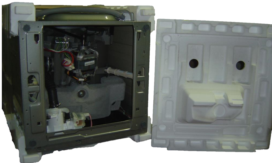
Fig 22. Embalaje para la base de la lavadora sin fondo junto con la lavadora
