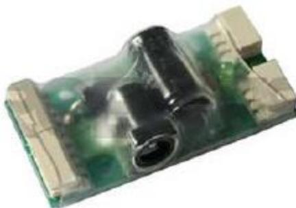
*Ilustración 15: SMPS2Dynamixel*
