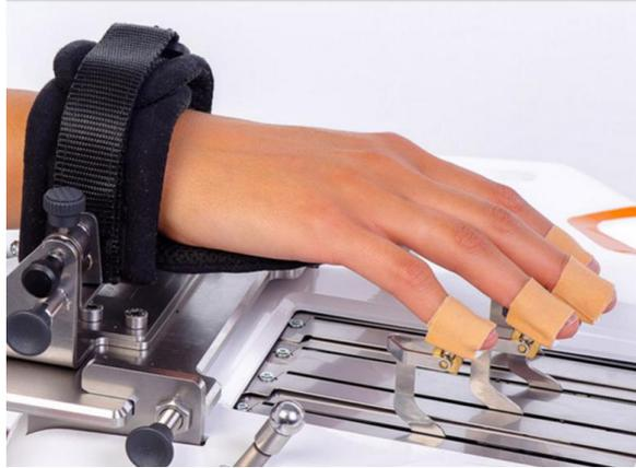
*Ilustración 5: Detalle de la parte de los dedos del robot Amadeo*
