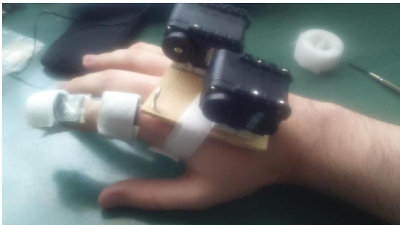
*Ilustración 24: Segundo prototipo visto desde arriba*
