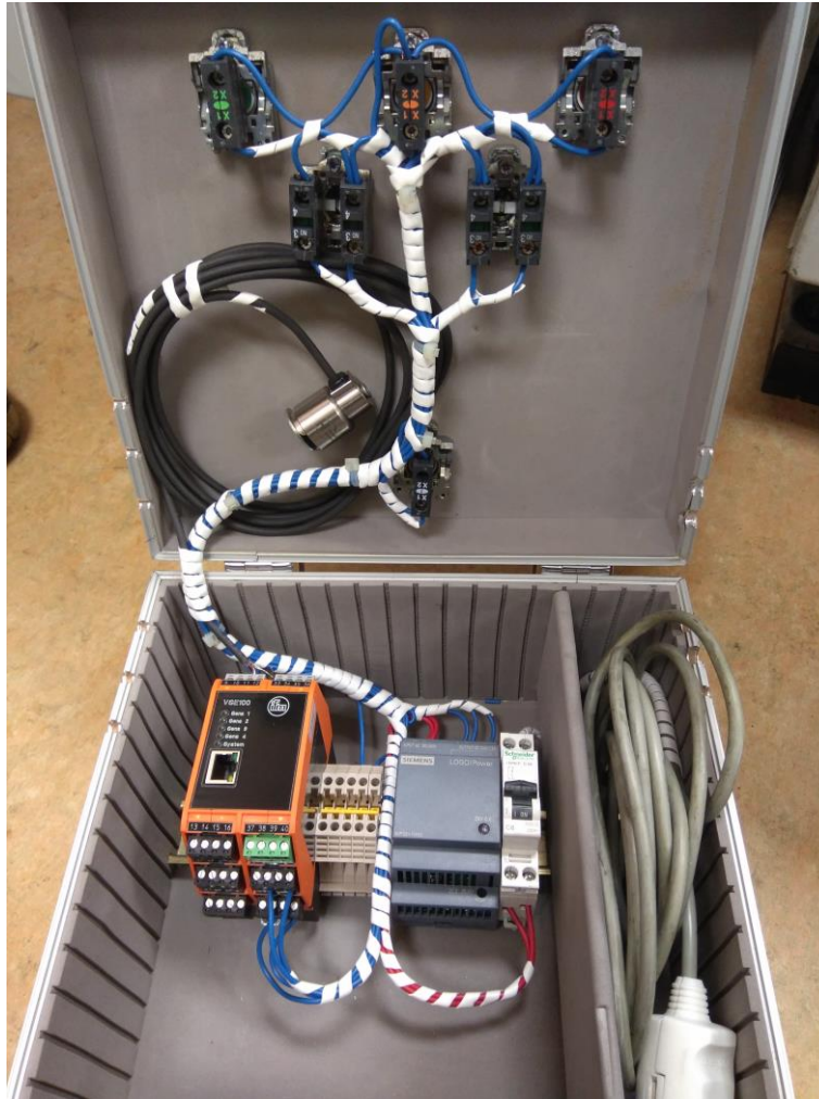
Ilustración 58 Detalle interior de maleta para el análisis de vibraciones
