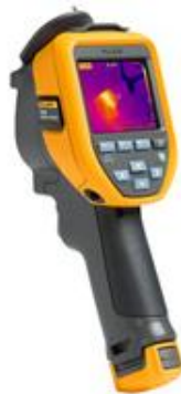
Ilustración 41 Cámara de infrarrojos
