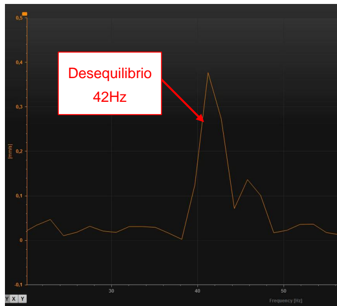
Ilustración 50 Espectro de velocidad (mm/s-Hz) entre 0Hz y 60Hz
