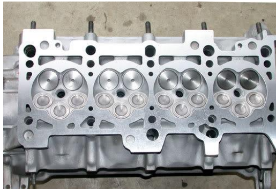
Ilustración 15 Cara inferior de la culata
