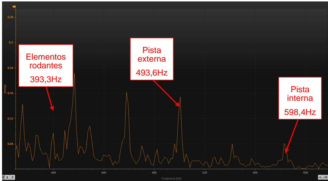
Ilustración 51 Espectro de velocidad (mm/s-Hz) entre 300Hz y 650Hz
