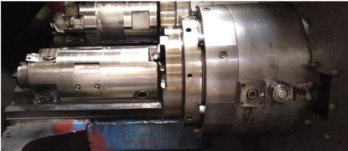
Ilustración 48 Acelerómetro atornillado sobre electrohusillo.
