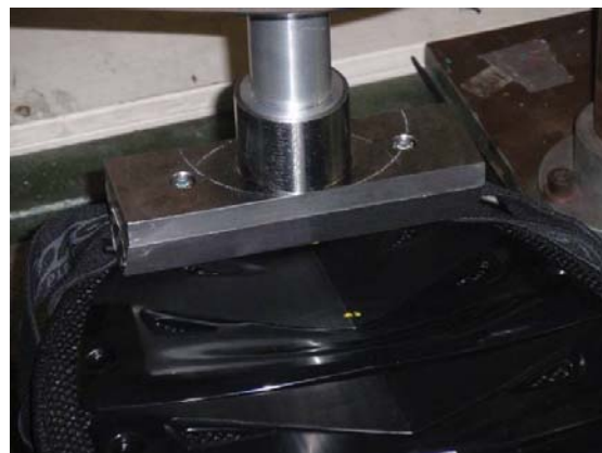
Imagen 11: Ejemplo de prueba de nivel superior de absorción.
