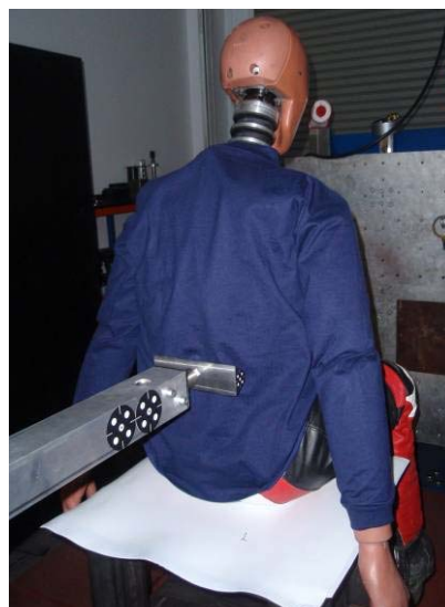
Imagen 9: Prueba realizada en Hybrid III sin protector de espalda.
