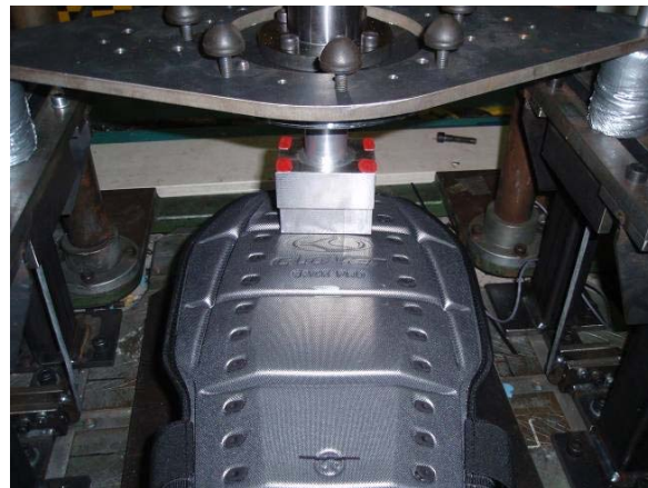
Imagen 10: Prueba de absorción y distribución en bloque
