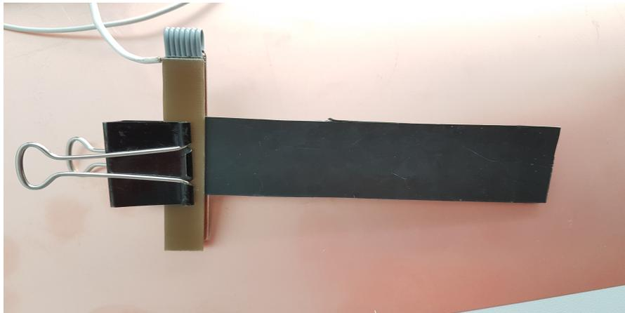
Figura 4.6: Foto del soporte del material a medir
