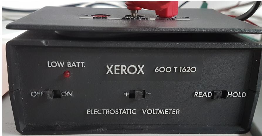
Figura 1.4: Voltímetro electrostático empleado
