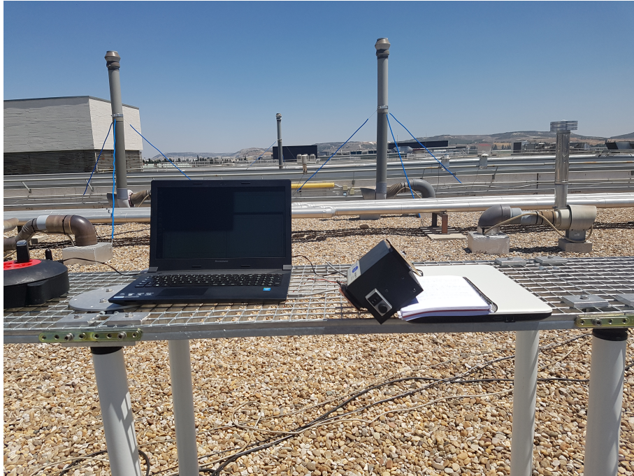
Figura 5.1: Imagen del sistema durante la medición del espectro del Sol con el GOA.
