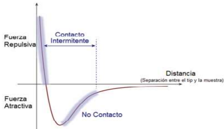
Fig. 10. Fuerzas en AFM y modos de operación.
