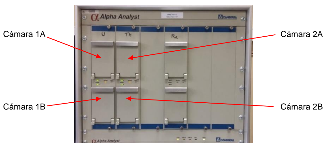
Fig.: 3.3 Equipo de espectrometría alfa con el cual se ha operado en la realización de este estudio.
