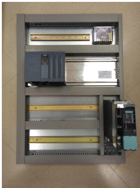
Figura 21: Montaje de carril DIN.
