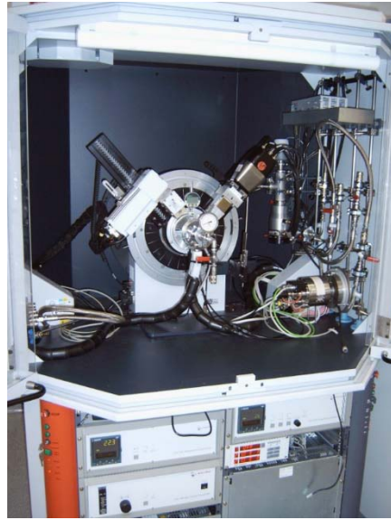
Figura 20. Analizador de Difracción de Rayos X BRUKER D8 DISCOVER.
