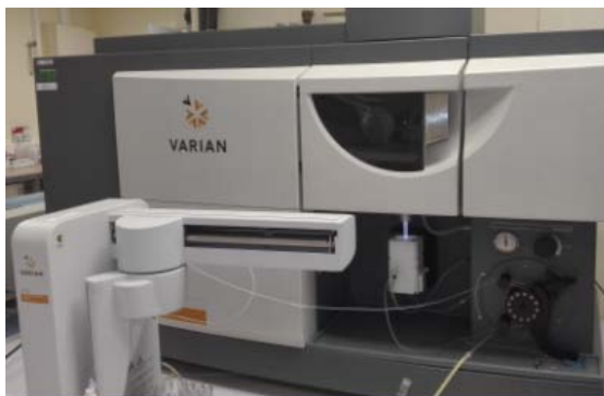
Figura 32. Espectrómetro ICP-OES Varian 725E.
