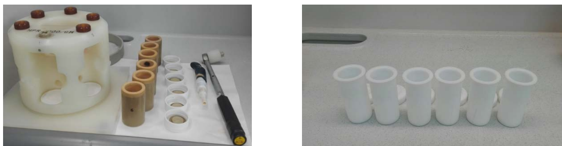
Figura 28. Carrusel, encamisados, llave dinamométrica y reactores
