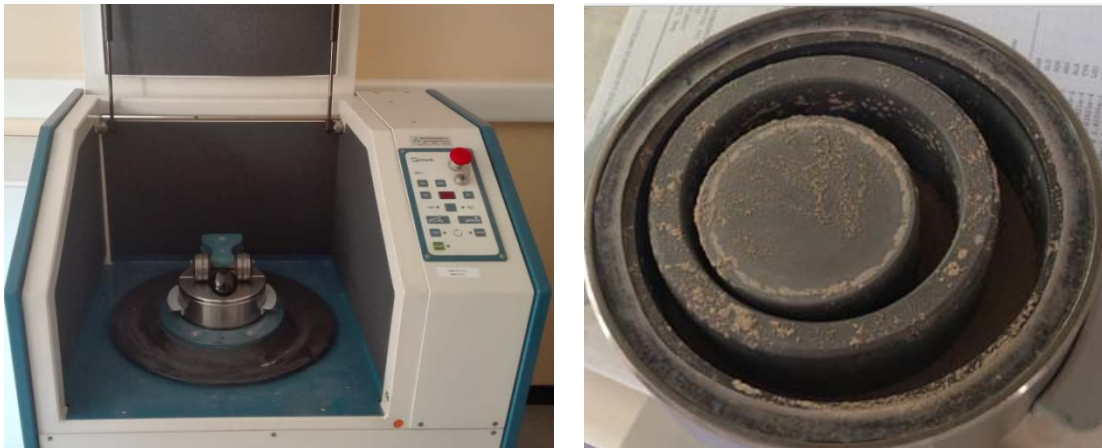
Figura 19. Molino de discos vibratorios RETSCH.
