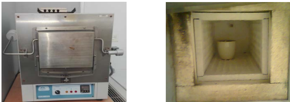
Figura 25. Calcinación de la muestra en la mufla.
