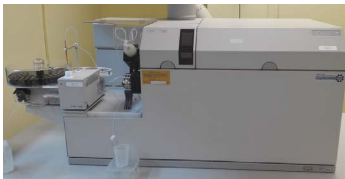
Figura 36. Espectrómetro ICP-MS Agilent 7500c.
