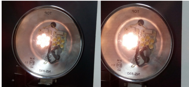
Fig. 4a y 4b: Diferencia de intensidad de luz halógena (izquierda) y luz xenón (derecha)
