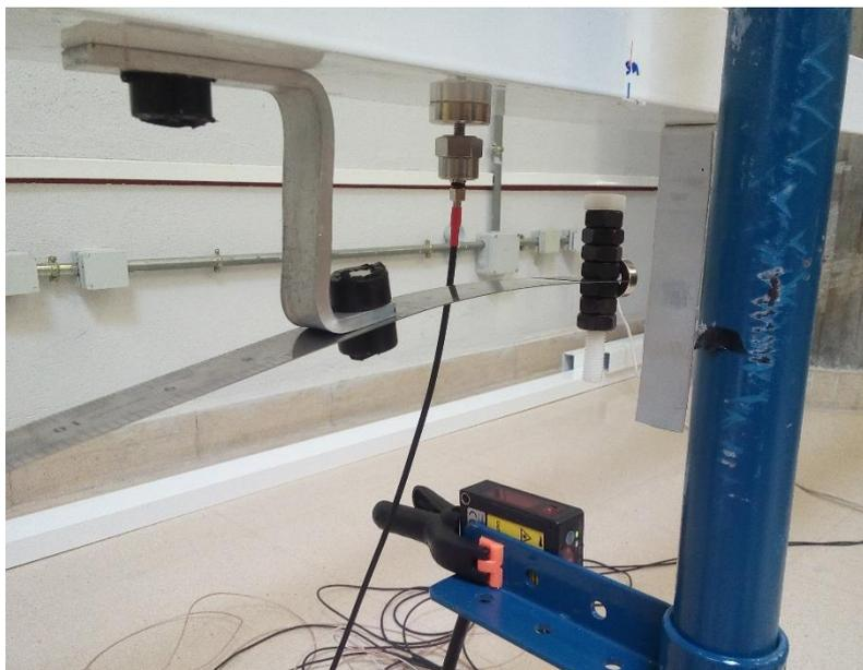
Figura 3-28. Montaje realizado para la sintonización del TMD.
