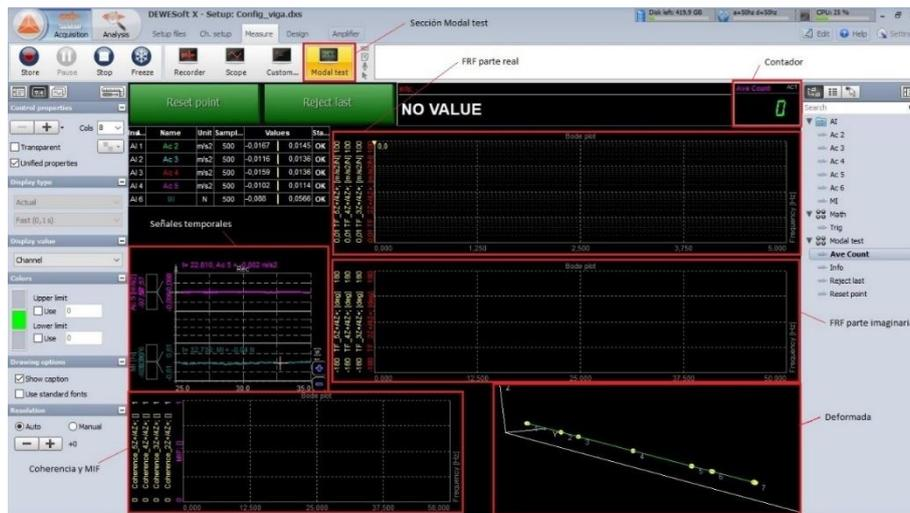
Figura A-6. Sección "Modal test".
