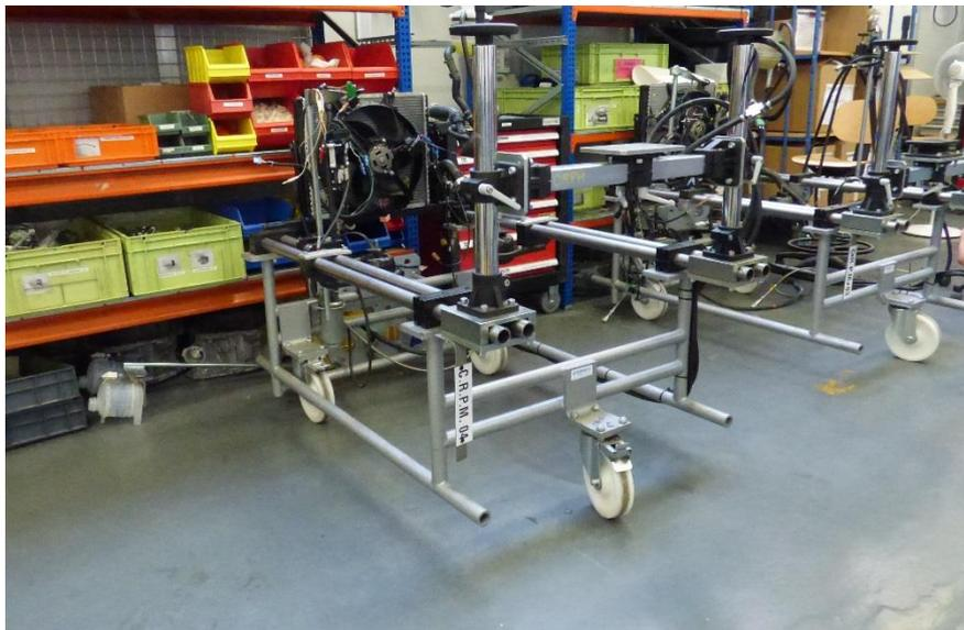
Figura 4.1.1.E. Carros para rodar un motor.
