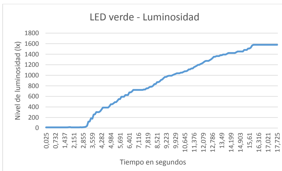
Ilustración 6.8.4 - Gráfica ejemplo LUMINOSIDAD - Luminosidad aumentando potencia eléctrica
