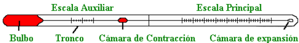
Ilustración 6.7.3 - Termómetro de mercurio, esquema de funcionamiento
