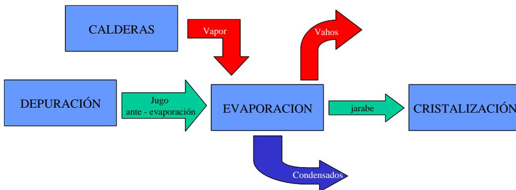
**Figura 3.3:** Esquema general de la fase de evaporación. Imagen extraída del Capítulo 6 de la Tesis Doctoral; Entornos distribuidos para simuladores de procesos.
