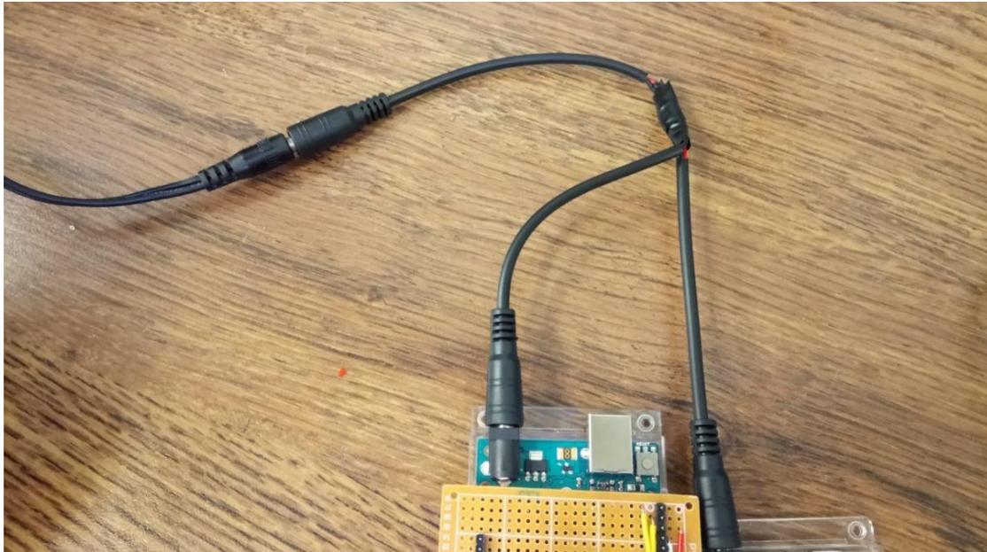
*Figura 26. Cable para alimentar con una sola fuente de alimentación.*
