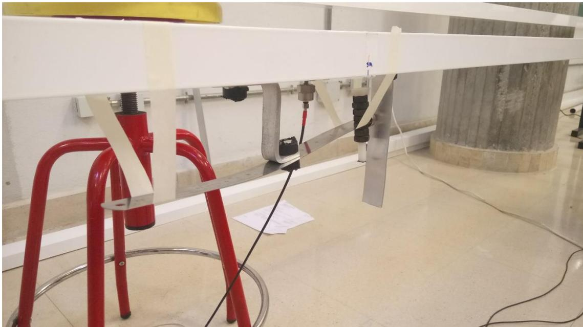
Figura 61. TMD instalado en la viga (anulado en la imagen).
