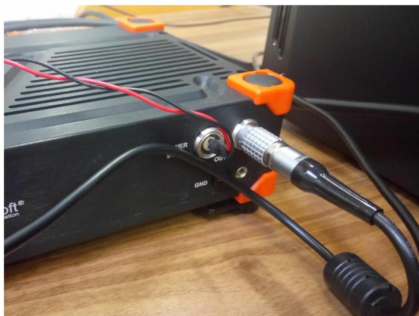
Figura 4. Toma de alimentación del láser.
