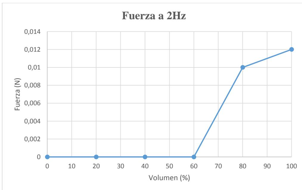
Figura 31. Fuerza para 2Hz. Shaker trabajando con la aplicación del móvil.
