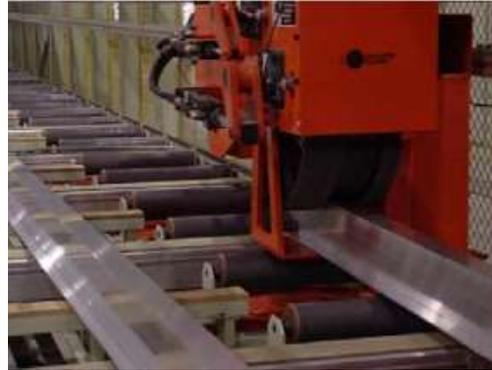
Figura 30: Puller sobre la mesa de salida.
