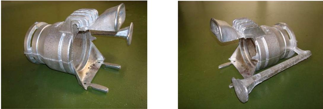
Figura 5: Conexión rápida con bebedero y mazarota.
