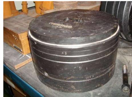
Figura 28: Matriz para perfiles huecos, se distingue la matriz con la cámara de soldadura y la prematriz con cuatro puertos de entrada.
