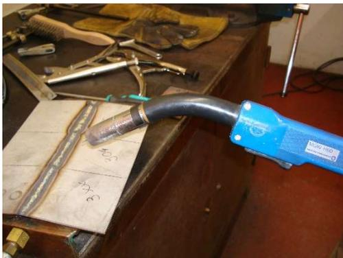
Figura 38: Pistola para soldadura semiautomática MIG/MAG.
