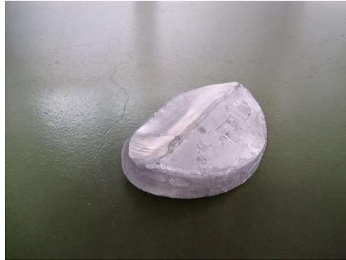
Figura 14: Culote de una extrusión.
