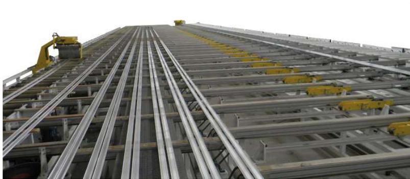
*Figura 32: Mesa para el manejo de los perfiles y cintas para su transporte.*
