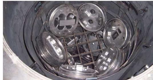
Figura 35: Horno de nitruración y matrices dentro del horno de nitruración.
