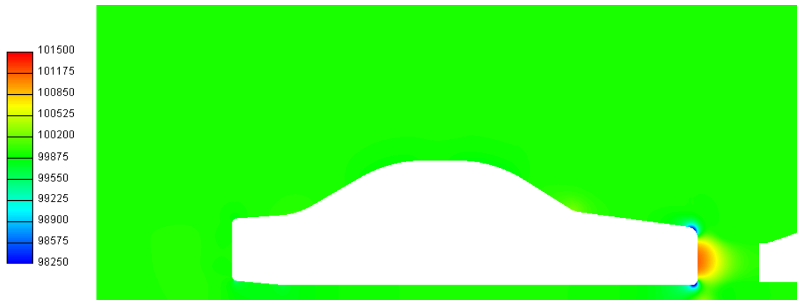
Figura 3.42: Contornos de presión [Pa], soplante 3 a 60 cm. Plano de simetría.
