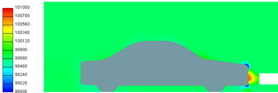
Figura 3.17: Contornos de presión [Pa], soplante 1 a 130 km/h. Plano de simetría.
