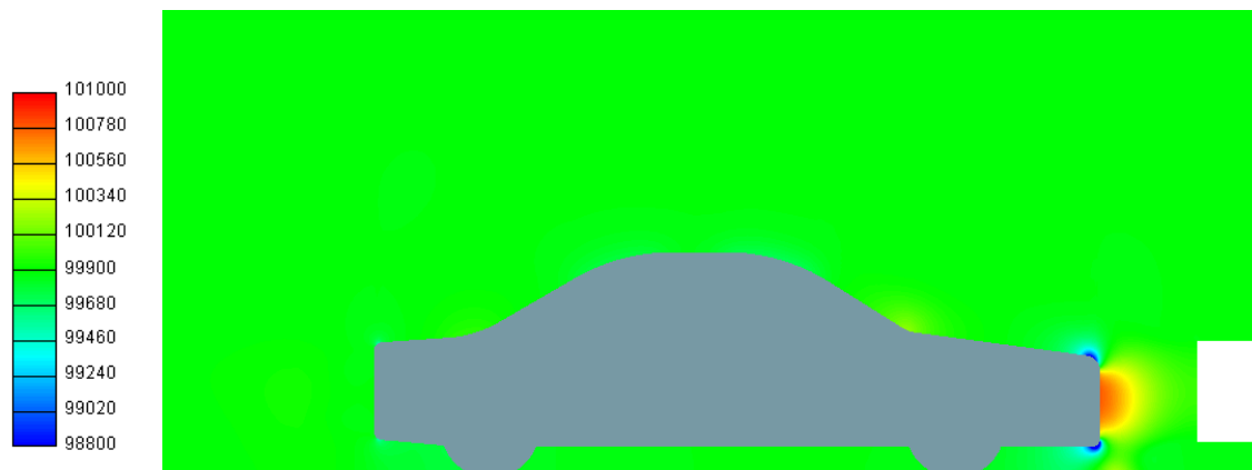
Figura 3.32: Contornos de presión [Pa], soplante 2 a 60 cm. Plano de simetría.
