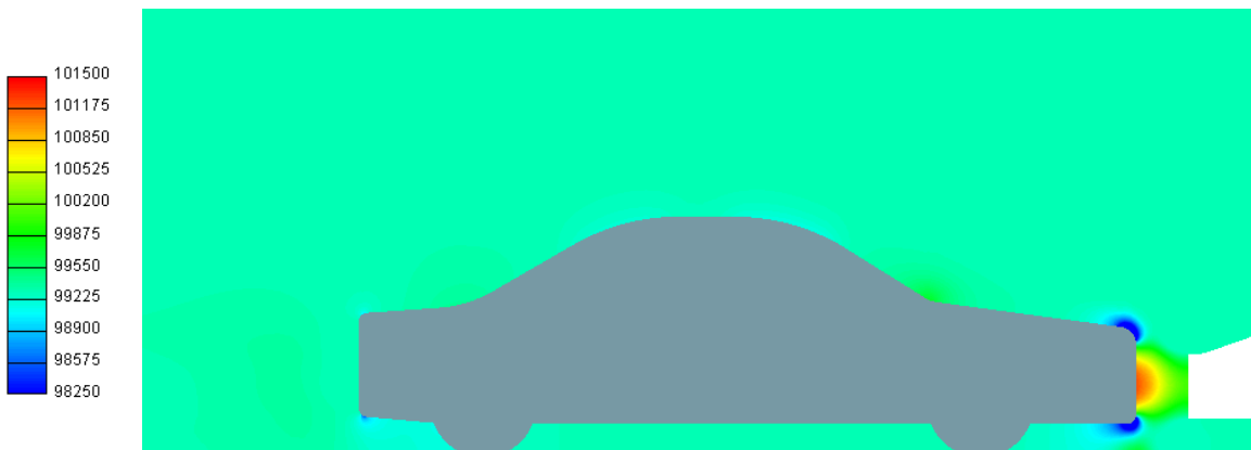
Figura 3.37: Contornos de presión [Pa], soplante 3 a 30 cm. Plano de simetría.
