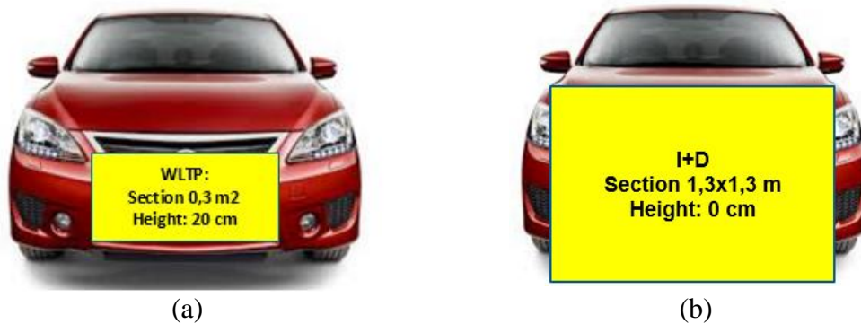
Figura 1.4: (a) Área de soplante requerida para un ensayo WLTP. (b) Ejemplo de área de soplante utilizada para test de I+D
