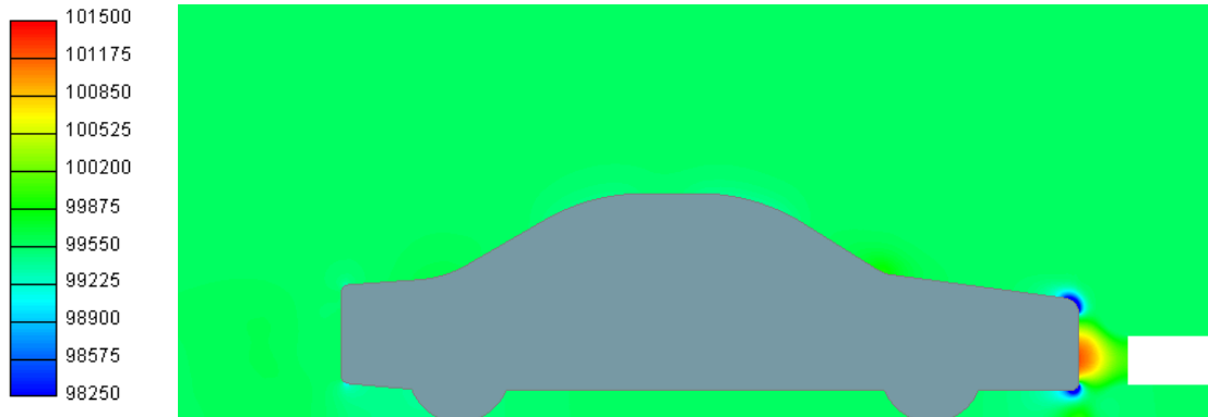
Figura 3.22: Contornos de presión [Pa], soplante 1 a 160 km/h, plano de simetría.
