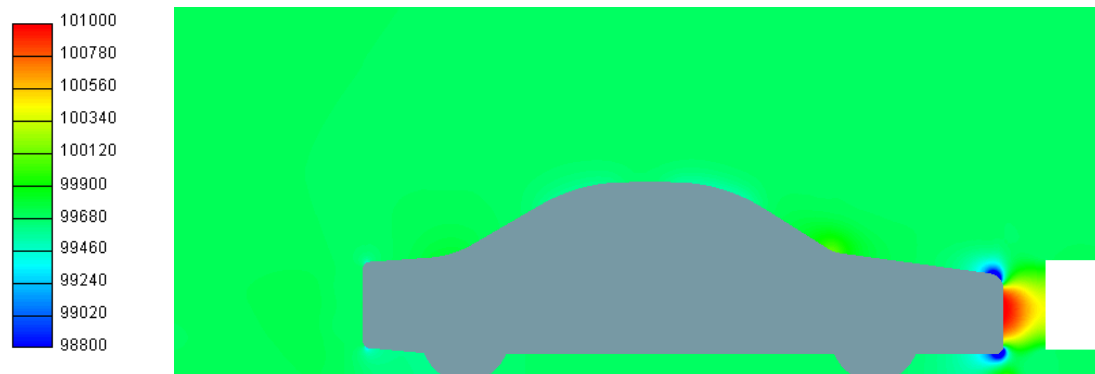
Figura 3.27: Contornos de presión [Pa], soplante 2 a 30 cm. Plano de simetría.
