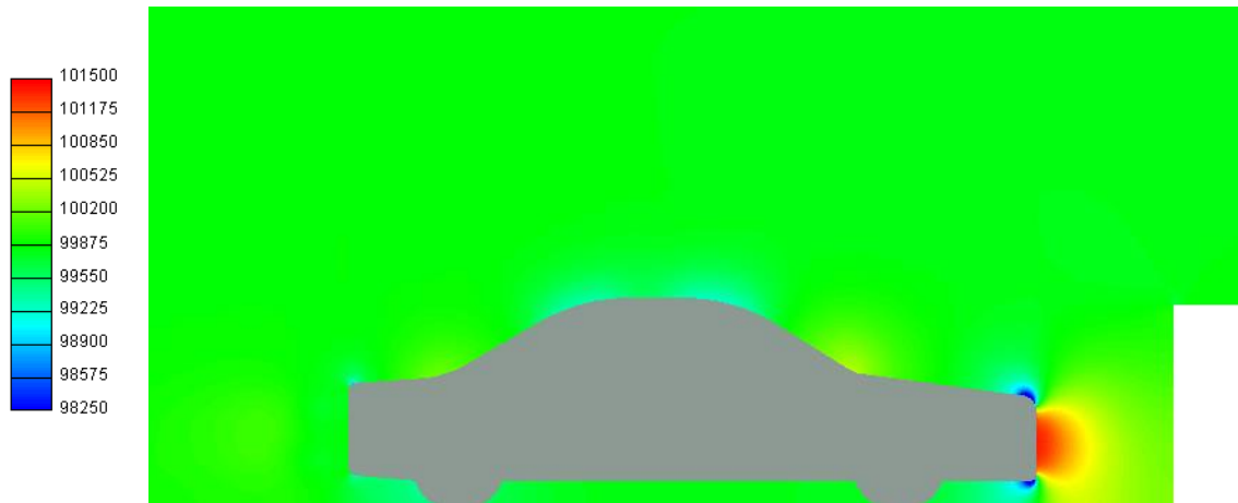
Figura 3.52: Contornos de presión [Pa], soplante 4 a 160 km/h. Plano de simetría.
