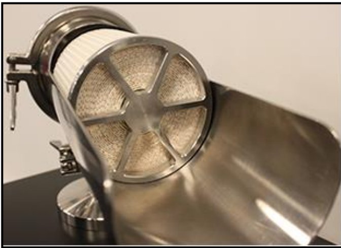
Ilustración 5-6: Vista de una configuración de membrana de placa y marcos de tipo espiral. Fuente: tetrapk.com
