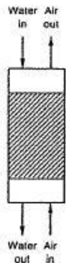
Ilustración 12: Patrón de flujo en contra corriente. Fuente: Metcalf-Eddy. Chapter 11
