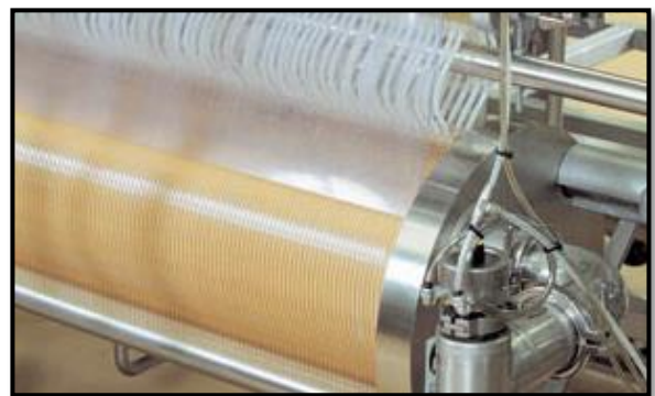
Ilustración 7-8: Vista de una configuración de membrana de placa y marcos de tipo almohadiformes o placa plana.
