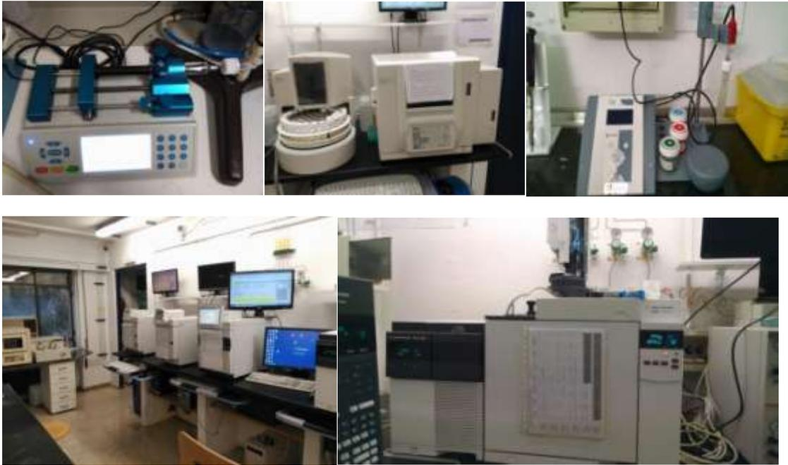
Figura 7. Instrumentación analítica utilizada en el laboratorio para la monitorización de los reactores. De izquierda a derecha: bomba de jeringa, analizador COT/NT, medidor de pH, cromatógrafos de gases ECD, FIC, TCD y cromatógrafo de masas. (Fuente: propia)
