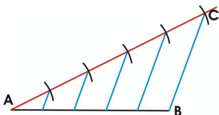
Sólo tendrán que trazar una recta que pase por un extremo del segmento, por ejemplo, A (y que no contenga a B) y con el compás determinar 5 segmentos de igual longitud. Si C es el extremo final, unimos C con B y trazamos rectas paralelas al segmento BC por cada uno de los extremos.
