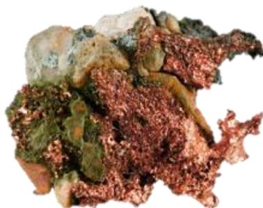
Fig54. Cobre Nativo. Muestra las superficies de fractura ganchuda.
