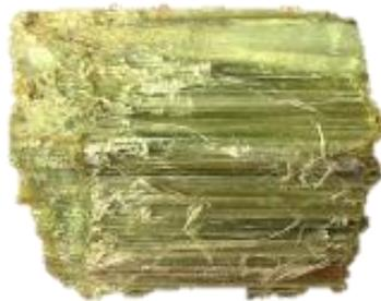
Fig53. Actinolita Muestra las superficies de fractura Fibrosa.
