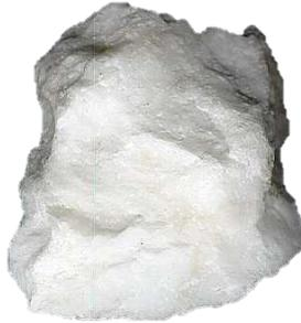
Fig55. Yeso sacaroideo. Muestra las superficies de fractura terrosa.
