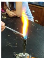
Fig77. Coloración de la llama con sodio
