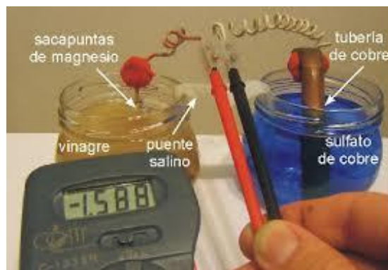
Figura 17: Pila casera con sacapuntas de magnesio y tubería de cobre 27
