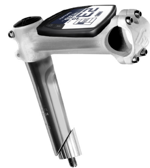
Ilustración 44: Imagen potencia con el controlador integrado.
