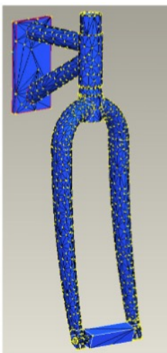
Ilustración 95: mallado horquilla. Hecho con CatiaV5
