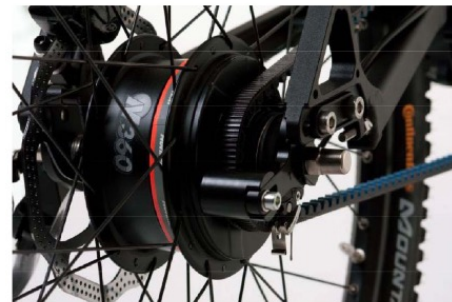
Transmisión por correa. Cambio interno NuVinci.
