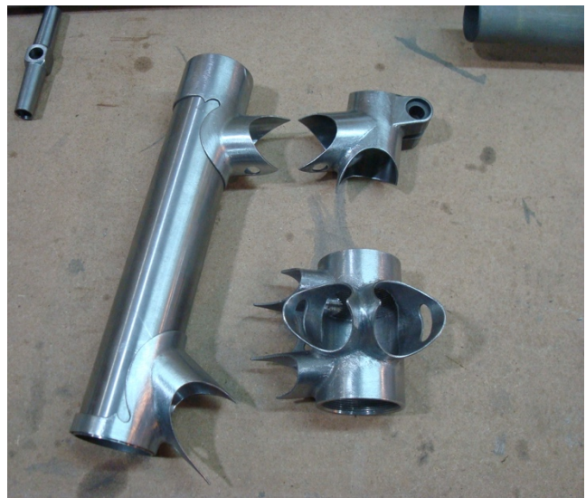
Ilustración 73: barra de potencia con el embellecedor delantero y unión del sillín.
