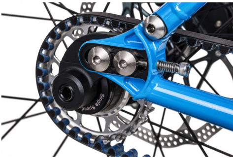
Ilustración79: Render uniones y punteras deslizantes empleadas.
