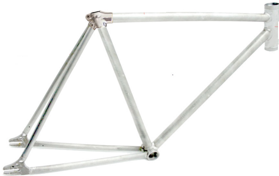
Ilustración 55: render del cuadro de aluminio de Gheppio. Hecho con el programa 3DMax
