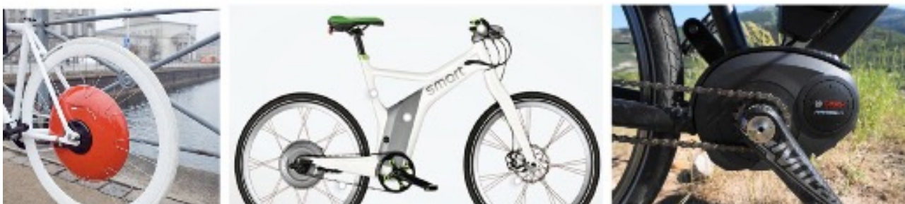
Ilustración 14: Ejemplo de las 3 posibles posiciones del motor.
