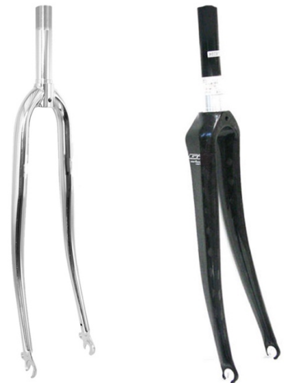
Ilustración 45: Horquillas Al (izq.) y carbono (derecha).
