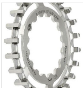
Ilustración 36: Imagen correa de carbono, piñón y plato empleados.
