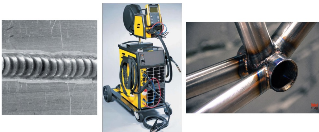
Ilustración 57: Equipo de soldadura AristoTIG-250 que emplearemos y resultados de soldadura.
