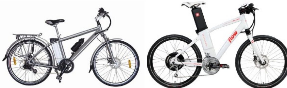
Ilustración 17: Ejemplos de posicionamiento de batería de una e-bike (2)
