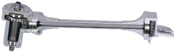
Ilustración 13: Ejemplo bicicleta con cardan.
