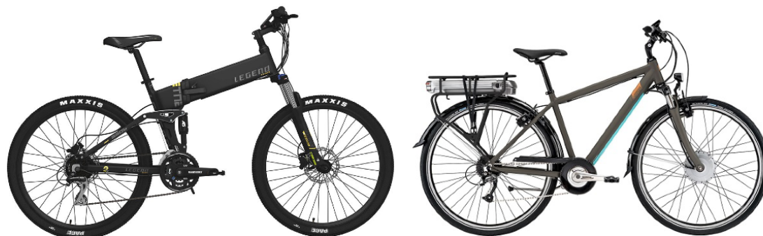
Ilustración 16: Ejemplos de posicionamiento de batería de una e-bike (1)
