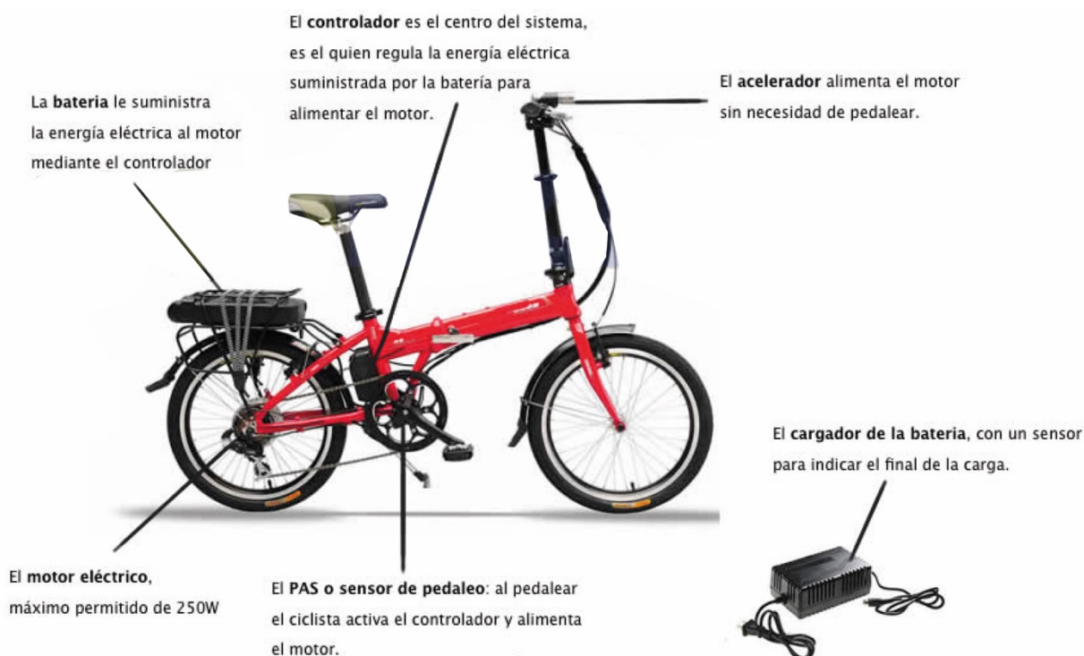
Ilustración 4: Principales partes de una bici eléctrica
